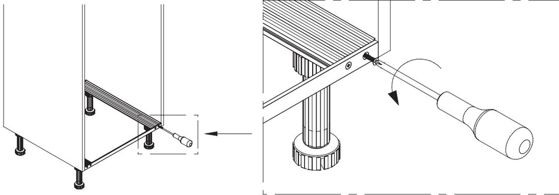
Togliere il profilo di chiusura del telaio T6567 svitando le 4 viti.
